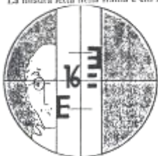
Figura 96. La stadia e chi la regge visti guardando nel livello ottico. La misura letta nella stadia è cm 162,5.
